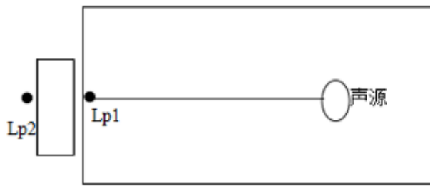
图 4-2 室内声源等效为室外声源图例
